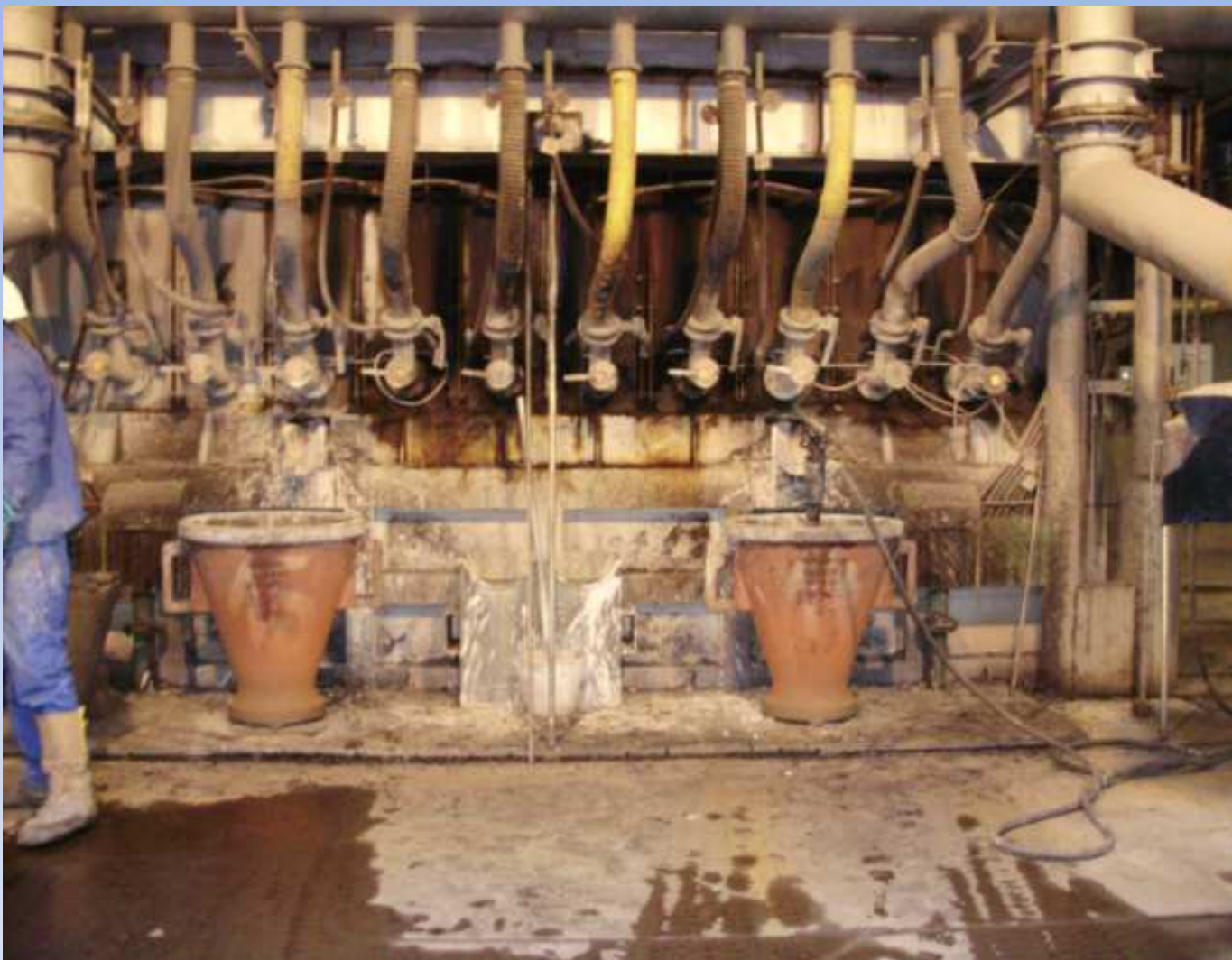
Kokily na záchyt strusky u šachtové pece
