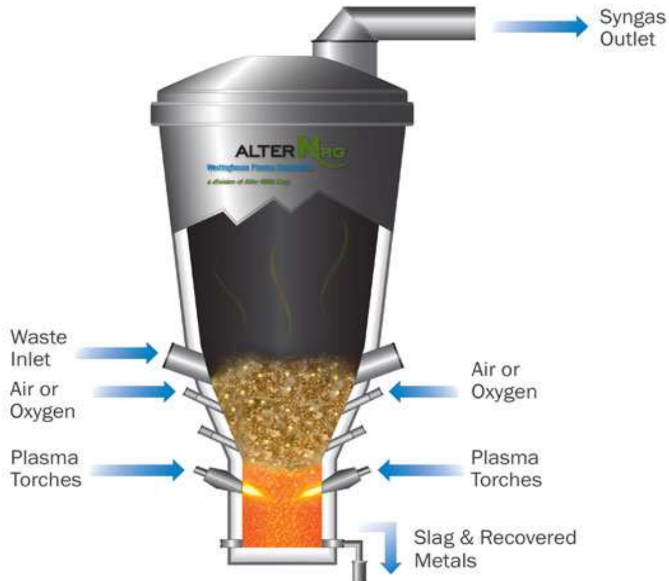
Obr. Princip plazmového zplyňování komunálního odpadu (Westinghouse Plasma Corporation (WPC), divize společnosti Alter NRG Corporation)
