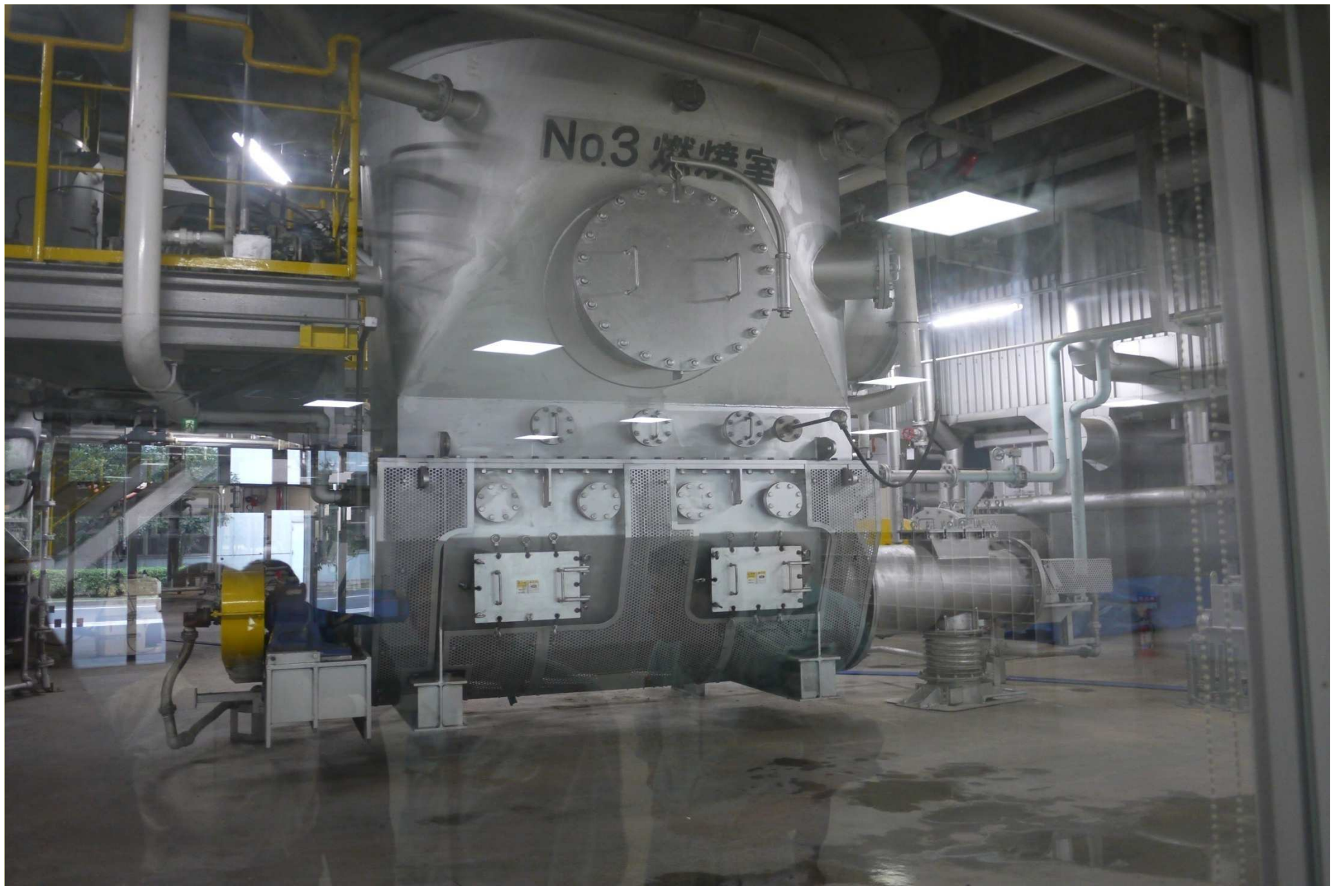
Obr. Kazusa Clean System – zplyňovací a tavicí pec
